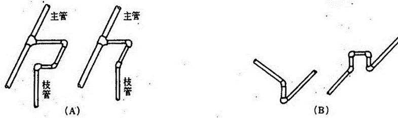
図 8.5 スイベル形伸縮可撓配管の例
